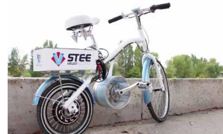
Le marché des VAE est en pleine expansion à travers le monde, dans un contexte de diminution de l'empreinte carbone de la mobilité. L'assistance électrique sur ces vélos est rendue possible par l'ajout d'un petit moteur qui intervient en appoint et permet une plus grande facilité de déplacement. L'énergie électrique provient généralement d'une batterie qui se charge par branchement sur secteur.
