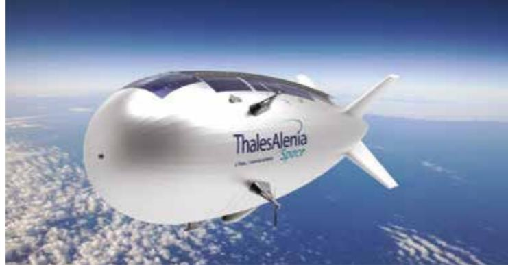
Ce système mesure 140m de long et a un diamètre de 32m. Pour rester en stationnaire et face au vent au-dessus de sa zone d'opération, il dispose de quatre hélices et quatre moteurs électriques. Sa surface comprend entre 970 et 1 100m<sup>2</sup> de cellules photovoltaïques qui procurent à la fois l'énergie à la charge utile et à son fonctionnement grâce aux deux gondoles de stockage d'énergie.
